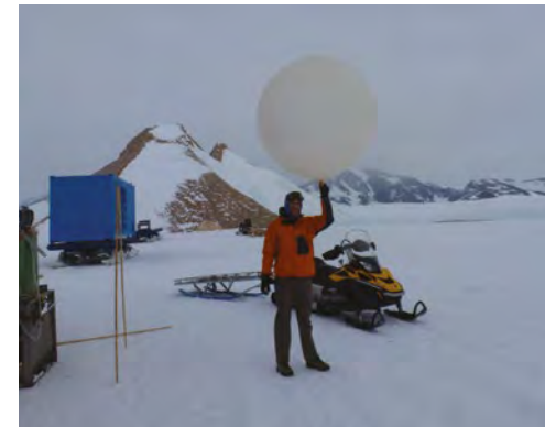
Figuur 7. Voorbereiding van de lancering van een weerballon voor een radiopeiling aan de Belgische poolbasis in Antarctica.
